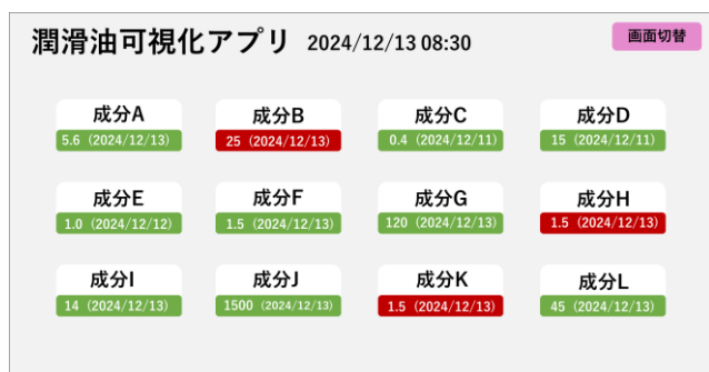
図 2 視覚的アラート機能付きカード型 UI Figure2 Card-style UI with Visual Alert Features.
