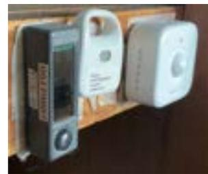
図4 人感センサおよび環境センサの設置例
